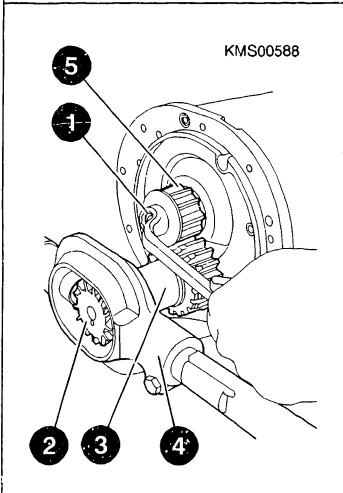
DISASSEMBLING REDUCTION GEAR (TYPE TF 0 001 613 ...)
